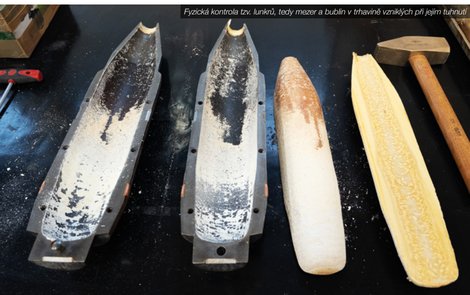
Fyzická kontrola tzv. lunek, tedy mezer a bublin v trhavině vzniklých při jejím tuhnutí
