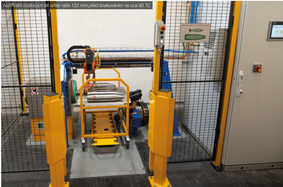
Nahřívání ocelových těl střely ráže 122 mm před šnekováním na cca 60 °C
