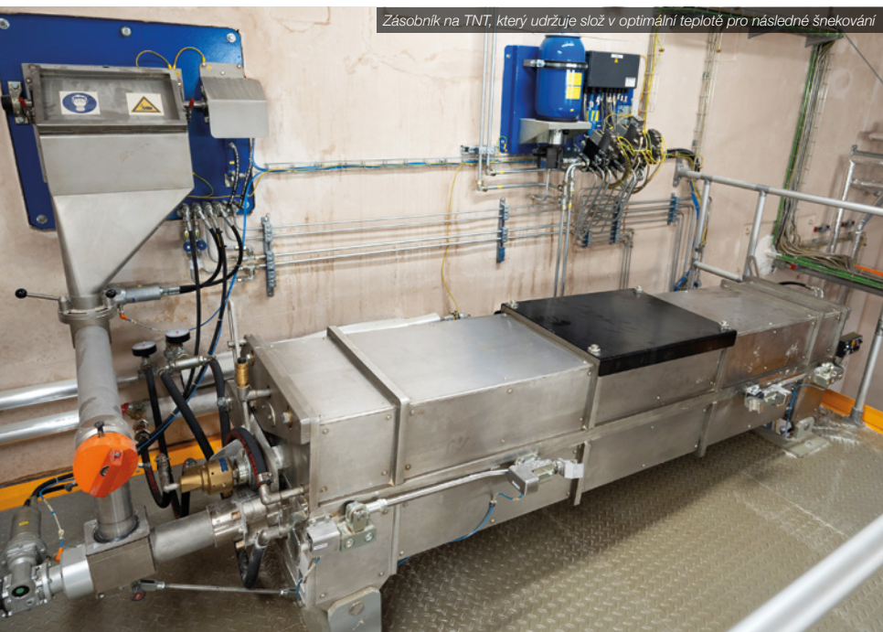
Zde se provádí vlastní šnekování a následné frézování přebytekové složky ze špičky střely
