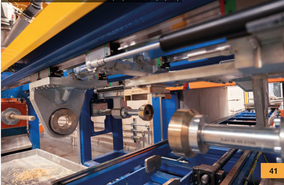
Zde se provádí vlastní šnekování a následné frézování přebytekové složky ze špičky střely
